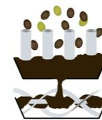
Le broyage de l'olive se fait grâce à une meule en pierre ou avec un broyeur mécanique, afin d'obtenir une pâte d'olives. Peau, pulpe et noyau sont écrasés ensemble. Le malaxage permet d'homogénéiser et de réunir les gouttelettes d'huile.
